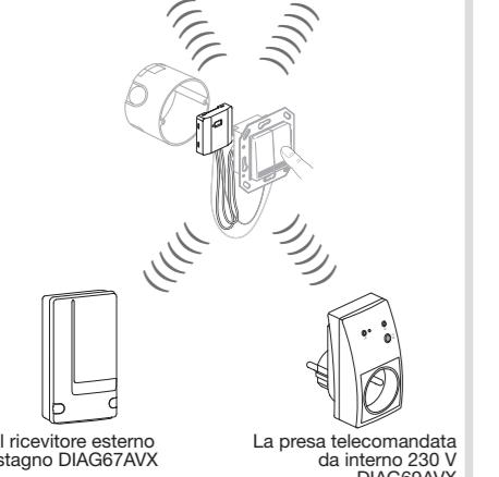
È possibile collegare un trasmettitore DIAG68AVX a un numero massimo di 20 ricevitori.
