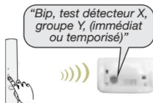
2. Vérifier la détection d'ouverture et de fermeture des issues protégées à l'ouverture et à la fermeture de l'issue, la centrale énonce :
